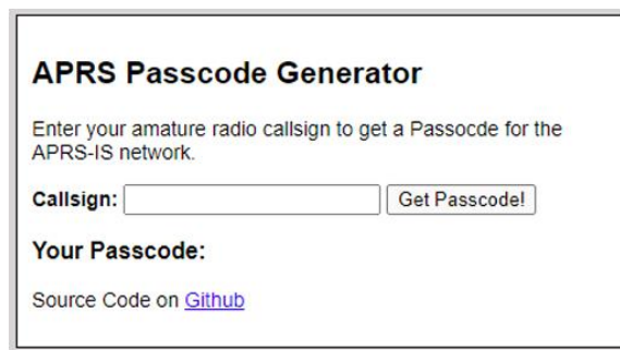
Rys. 1.3.7. Dodatkowy krok przy ładowaniu konfiguracji bramki radiowo-internetowej (po lewej) Rys. 1.3.8. Okno generatora hasła dostępu do APRS-IS. Należy wpisać w nim znak wywoławczy lub przyjętą nazwę bramki i nacisnąć przycisk „Get Passcode!” (po prawej). Niektóre ze spotykanych w Internecie generatorów haseł dostępu generują dla znaków stacji z rozszerzeniem inne hasła niż dla znaku podstawowego. Hasła te nie są przyjmowane przez sieć APRS-IS
