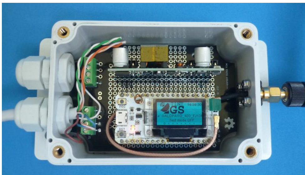
Fot. 3.8. Przykład umieszczenia odbiornika w hermetycznej obudowie
